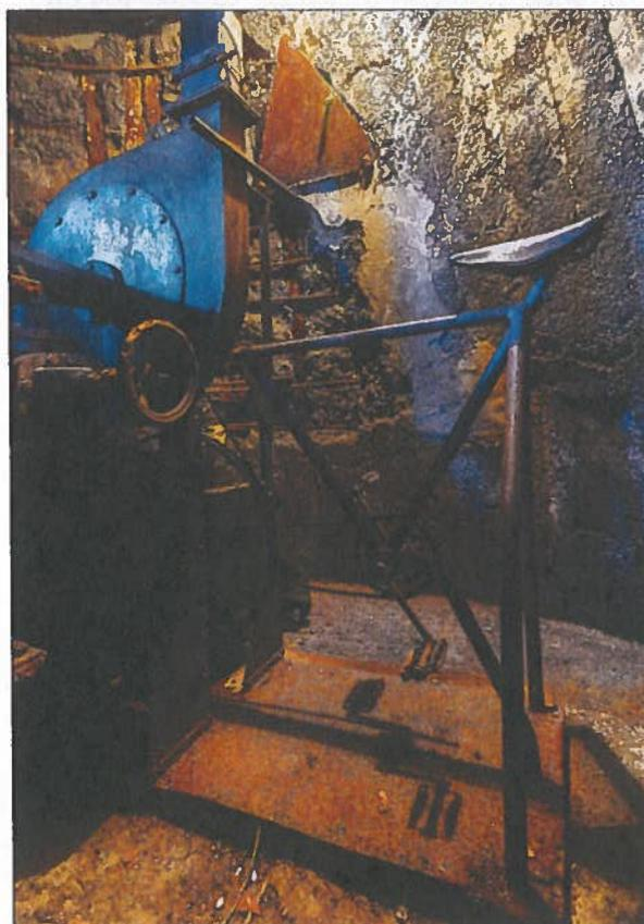
Vélo situé en haut du cône, permettant d'actionner le système de ventilation - Photo Nicolas Dudot
